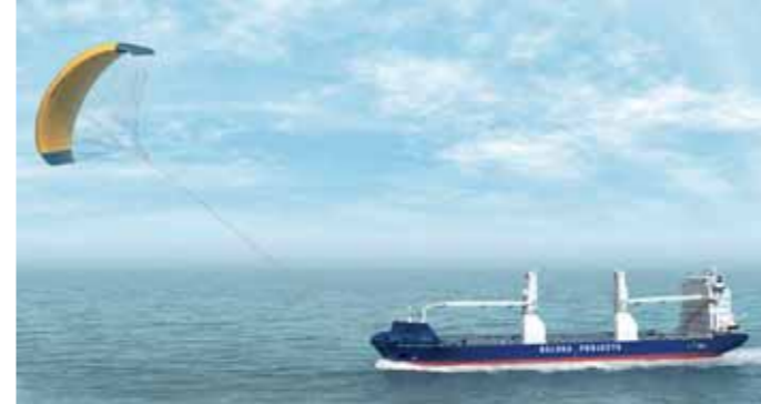
Umweltfreundlicher Antrieb für die Schiffe von morgen: Das SkySails-System norddeutscher Ingenieure soll per Zugdrachen Yachten, Frachtschiffe und Tanker über die Weltmeere befördern.
